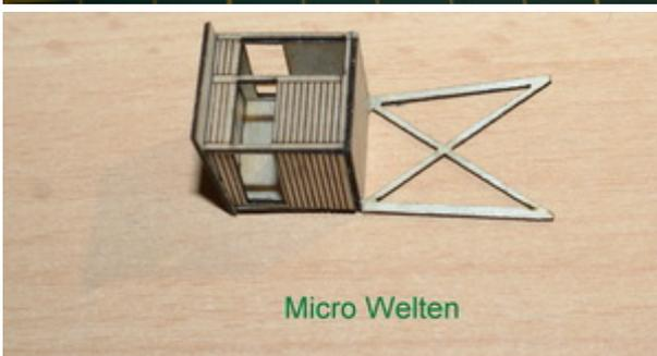
Zuerst die hintere Stütze ankleben und etwas antrocknen lassen.
